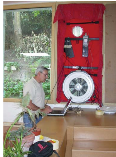
Porte soufflante (Blower Door) Q_{\max} = 10\ 000\ \text{m}^3/\text{h}
