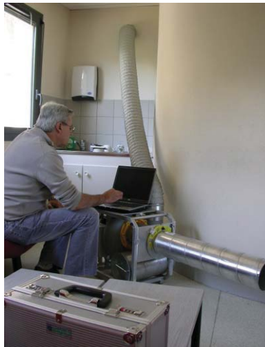
Perméoscope Q_{\max} = 1\ 200\ \text{m}^3/\text{h}
