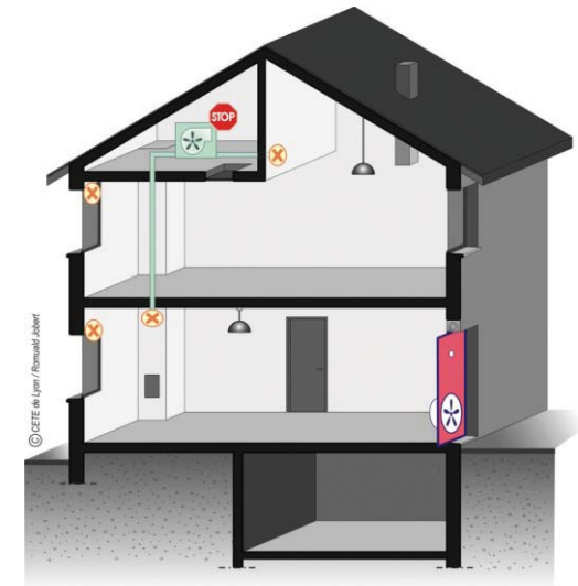
3. Installation de la porte soufflante ( Blower Door )
